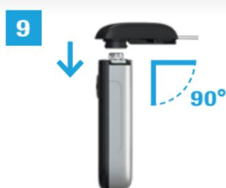
Posizionare un adattatore nuovo sulla presa a baionetta del vano portacartuccia. Assicurarsi di inserire ad angolo retto la testina dell'adattatore nelle tacche di posizionamento del microinfusore. In caso contrario l'ago si potrebbe piegare.
