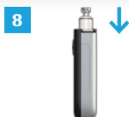
Assicurarsi di tenere il microinfusore in posizione verticale. Inserire la cartuccia (per primo il lato con lo stantuffo) nel vano portacartuccia.
