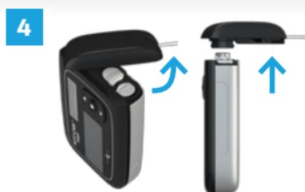
Tenere il microinfusore in posizione verticale. Ruotare l'adattatore con il catetere in senso antiorario fino a raggiungere un angolo di 120°. Rimuovere l'adattatore con la cartuccia.
