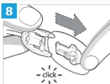
8 Collegare il catetere riempito alla base del connettore. Prima di riprendere la terapia insulinica con microinfusore, eseguire il riempimento cannula.
